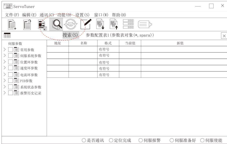
图 3 通过参数表读写伺服参数
