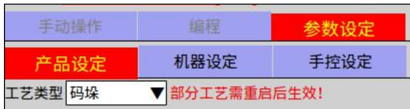
图 2.1: 启用码垛工艺
